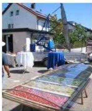
Le séchoir tunnel, avec ventilation propulsée par une cellule solaire photovoltaïque, un projet en cours...
